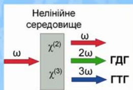
Схематична ілюстрація та схема експериментального вивчення процесів генерації другої та третьої оптичної гармоніки (ГДГ та ГТГ)
